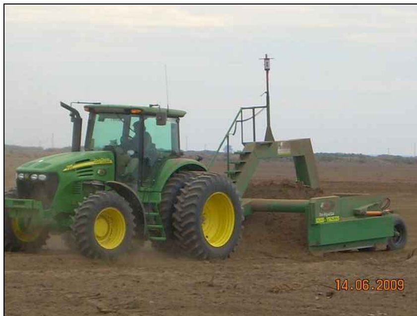
Fig. 11. Tractor agrícola con equipo de nivelación láser.
