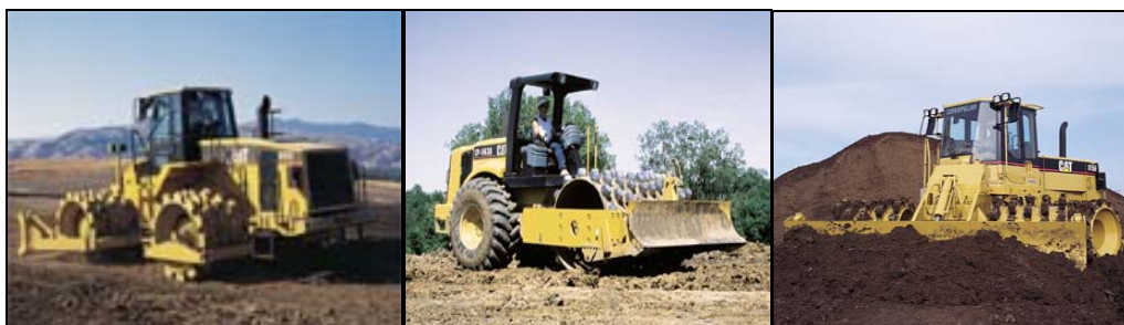
Fig. 18. Maquinaria con rodillo “pata de cabra”.
